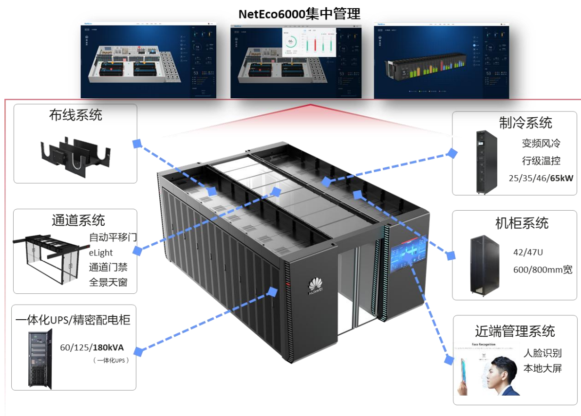
智能微模块技术系统架构图
