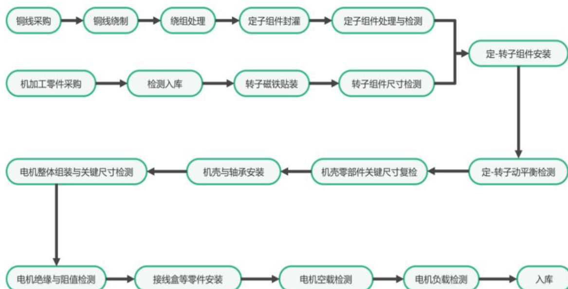
“无铁芯”盘式智能模组变频电机工艺流程图
