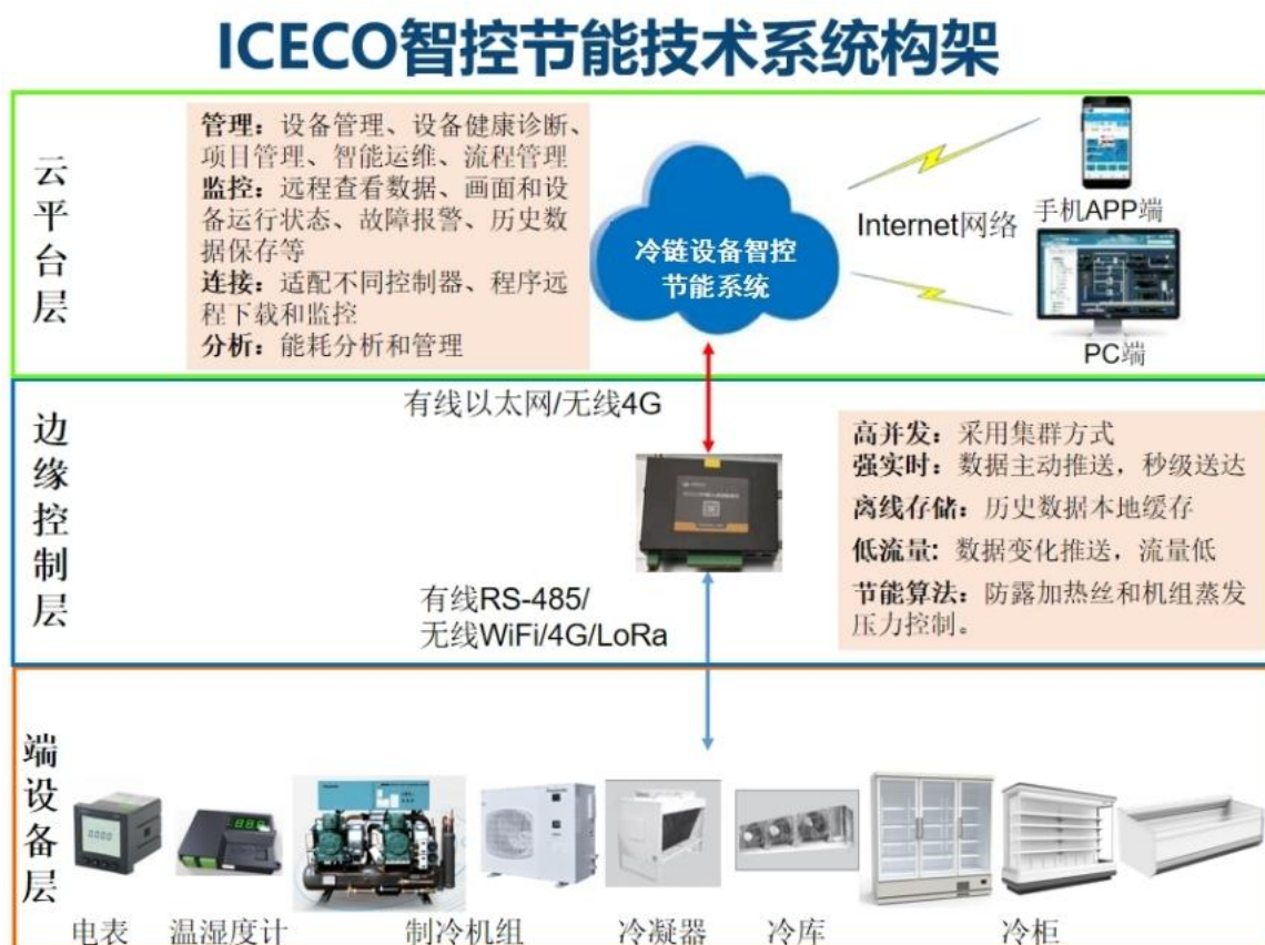
冷链设备智控节能系统架构示意图
