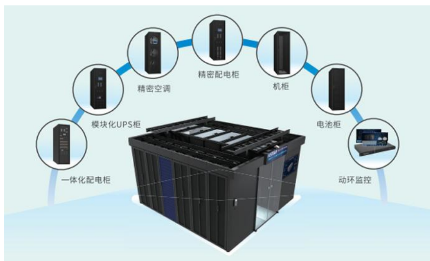
智能微模块化数据中心技术原理图
